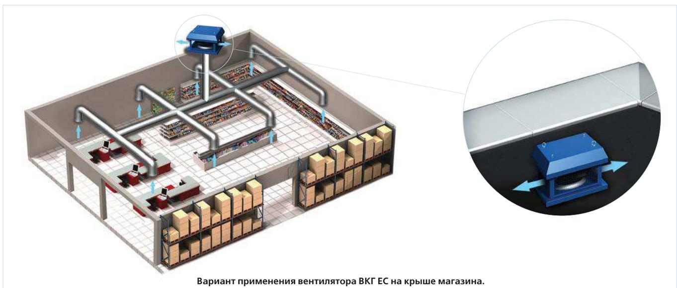
Вариант применения вентилятора ВКГ ЕС на крыше магазина.
